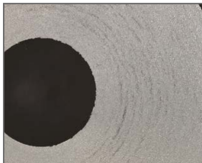
Kąt przystawienia 6° – Rz 11.3 μm
