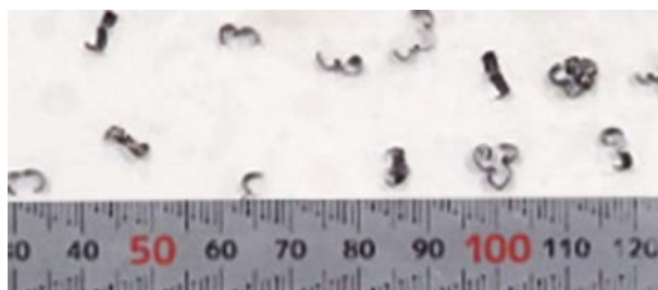
Pozostawiony czopik: \varnothing 1.42 mm, Rz: 0.015 mm
