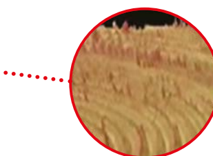
W miejscu o niskiej prędkości skrawania (blisko osi) chropowatość powierzchni może być większa
