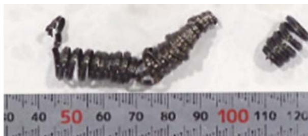
Pozostawiony czopik: \varnothing 0.58 mm, Rz: 0.043 mm
